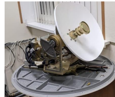
Антенная система 0,32 м для вертолетов (спецификация по требованиям КТ-160G)
