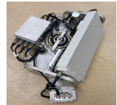
Антенная система 0,45 м для самолетов (2-х осевая стабилизации и 4-х осевое слежение)
